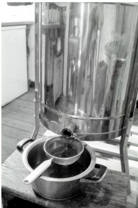
*Eine Honigschleuder funktioniert mit Zentrifugalkraft. Es gibt Tangential-, Radial- und Selbstwendeschleudern.*
